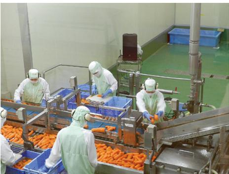
約1780万箱で、年4億本を製造するカゴメ最大の工場だ」などと紹介。同工場で使用する生原料加工はトマト1・8万トン(7~9月)、にんじん1万トン(10~3月)で、にんじん加工では、原料を荷卸しし、土砂ブラシできれいにした後、高圧ジェット・第一剥皮・第二剥皮を経て、人の手で選別。その後破碎され、搾汁。搾汁後のパルプは摩砕し、飲料や食品の加工原料となる。
