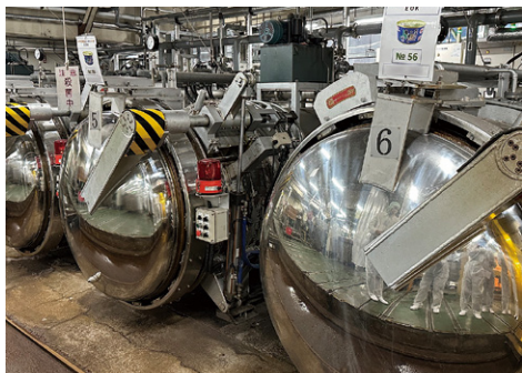
大型レトルト釜で加熱加圧殺菌
